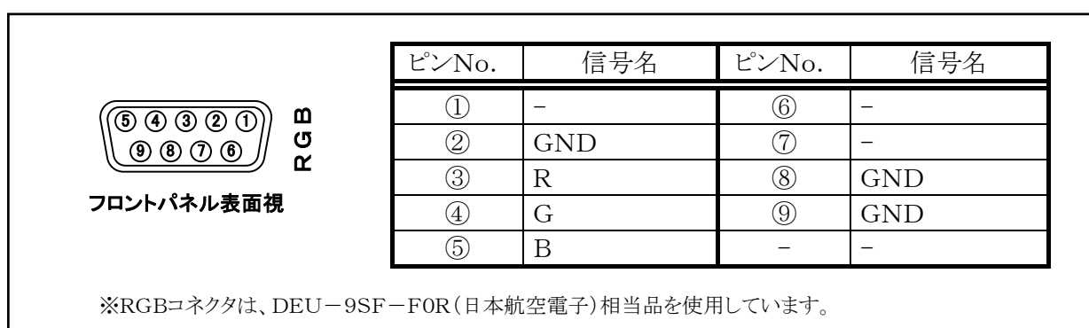
図2-14 RGBコネクタのピン配置
